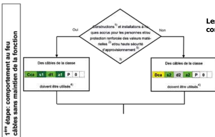
3.5 Diagramme de sélection pour câbles
