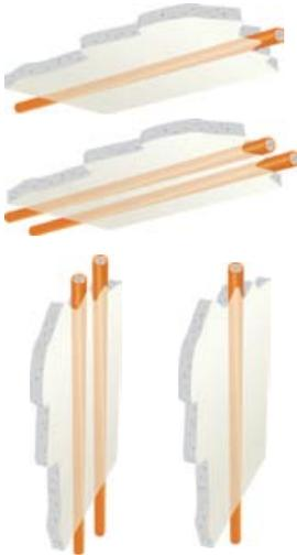
(Mineralische Putzüberdeckung auf dem Kabel  $\geq 15$  mm)
