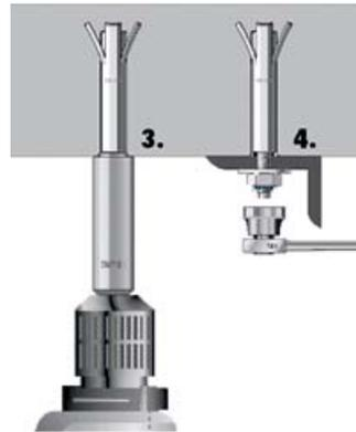
3. Mit Setzwerkzeug und Hammerschlag des Bohrhammers Sprezhülse eintreiben
